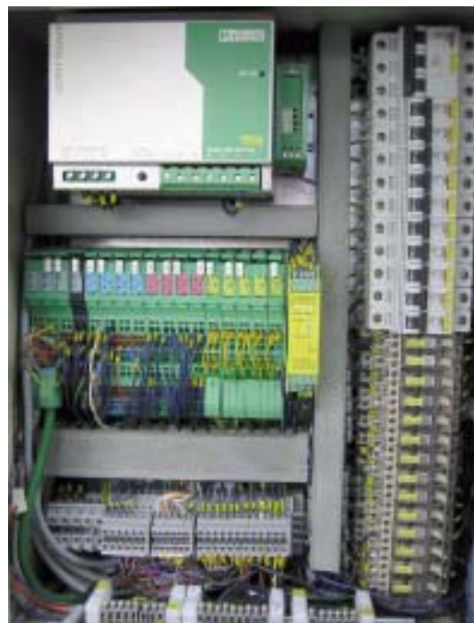
Suurten kappaleiden suihkupuhdistukseen tarkoitettua liikuteltavan laitteen ohjauskotelo.
