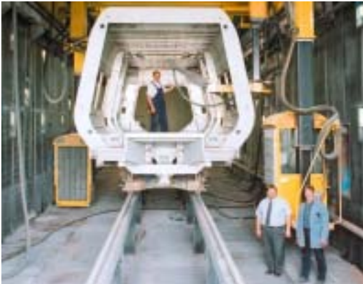
Blastman-puhallusmanipulaattorit uusilla roboteilla ja viimeisellä ohjaustekniikalla varustettuna Alstom Salzgitterissä Saksassa.
